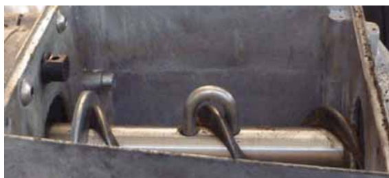
Prikaz 6-1: Pričvršćivanje spirale na pogon
