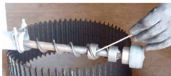
Prikaz 6-7: Učvršćivanje spirale
