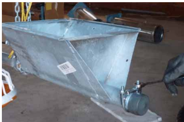
Prikaz 6-2: Otpuštanje stremena oblika U
